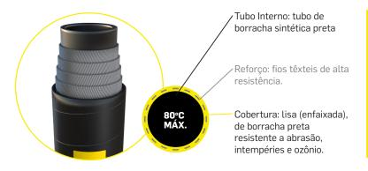
**APLICAÇÃO**Para condução de ar comprimido em sistemas de freio ferroviário. Atende a norma AAR-601.
